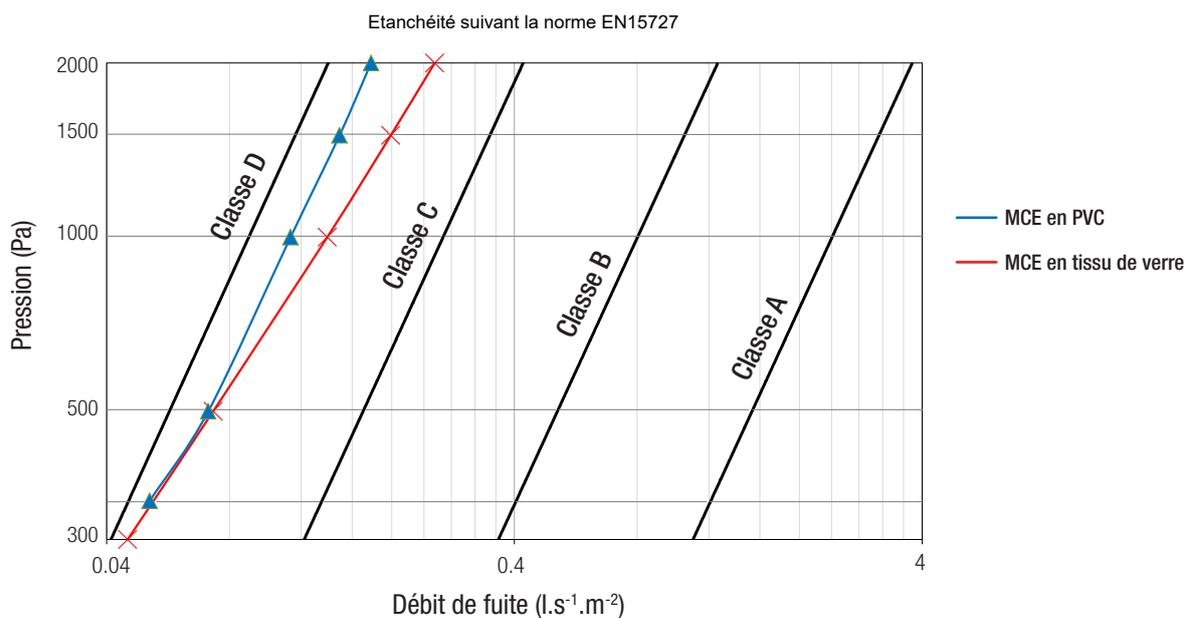
Tests réalisés sur une manchette MCE Ø250 mm, raccords mâles.
