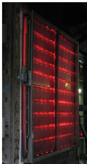
Le registre TRS a été testé 250°C/3h, 400°C/2h en vertical et horizontal suivant le protocole suivant :
