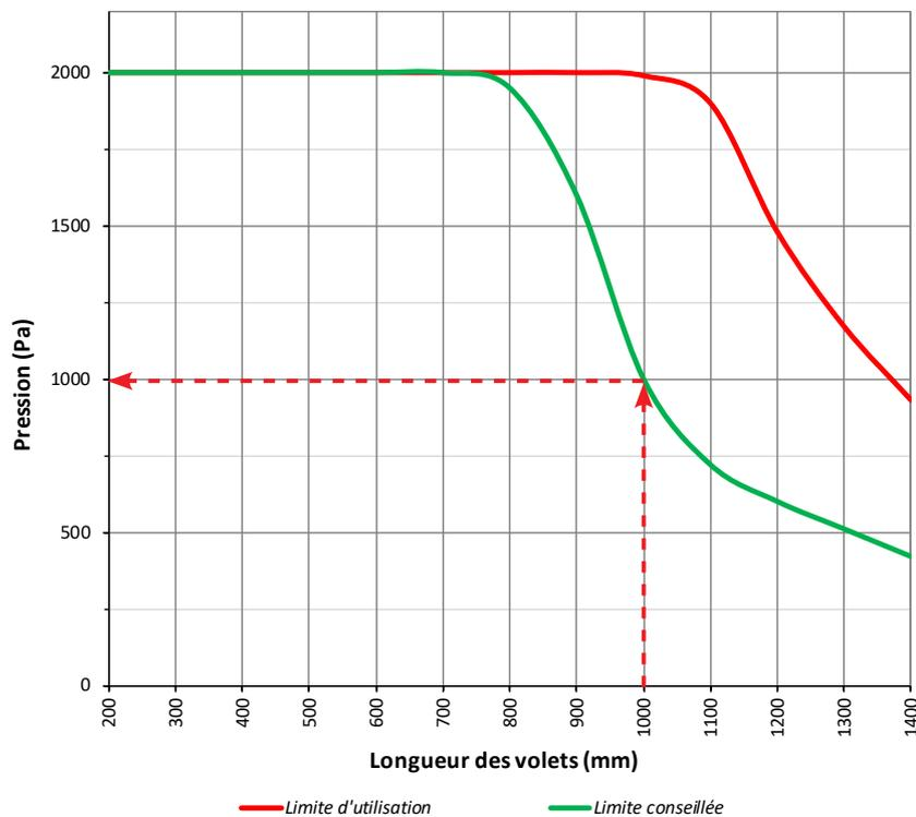
Nous recommandons de ne pas dépasser une pression différentielle de 1000Pa pour un registre U d'une longueur de 1000mm. Au-delà des limites d'utilisation, construction possible avec renfort intermédiaire.
