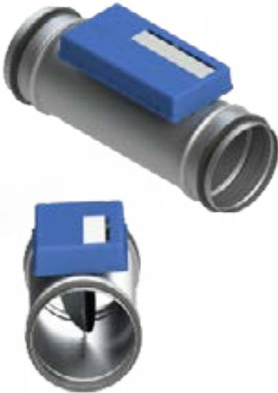
Le registre RCC est un système de régulation de débit constant autonome permettant de maintenir un débit constant dans le réseau de ventilation malgré les variations de pression
