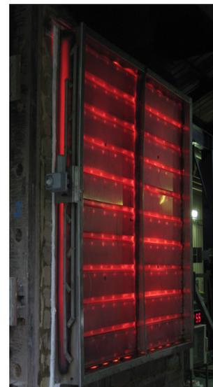
Le registre TRS a été testé 250°C/3h, 400°C/2h en vertical et horizontal suivant le protocole suivant :
