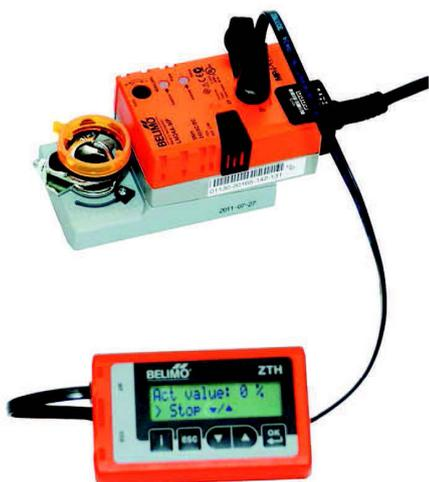
Le signal de commande du régulateur est 2-10 V sur RCVS (signal 0-10V possible sur demande ou modifiable sur site avec la télécommande ZTH-EU en option, nous consulter).
