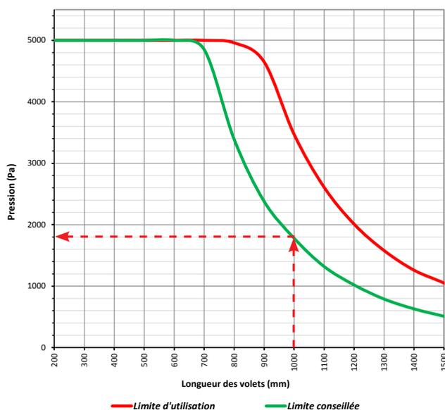
**Clapet AE :** Nous recommandons de ne pas dépasser une contre-pression de 1800Pa pour un clapet AE d'une longueur de 1000 mm
