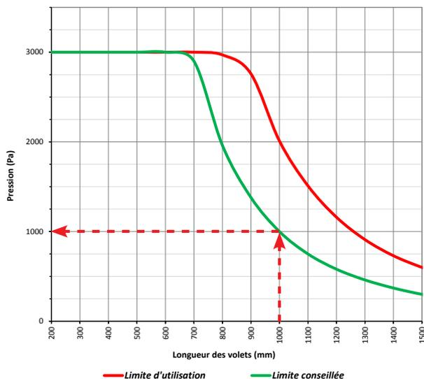
**Clapet AR :** Nous recommandons de ne pas dépasser une contre-pression de 1000Pa pour un clapet AR d'une longueur de 1000 mm
