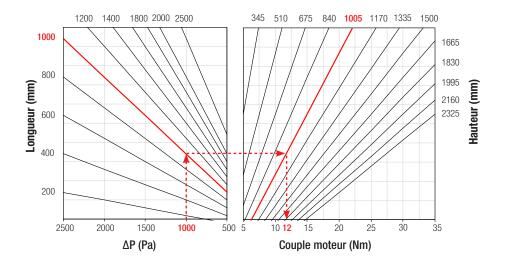
Coefficient à appliquer au résultat pour un registre avec renfort intermédiaire = 1.5
