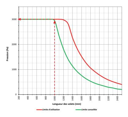
Nous recommandons de ne pas dépasser une pression différentielle de 3000Pa pour un registre M d'une longueur de 1000mm. Au-delà des limites d'utilisation, construction possible avec renfort intermédiaire.
